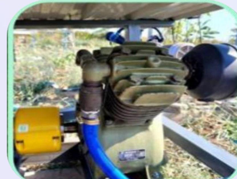
(4) 3HP Air Compressor
