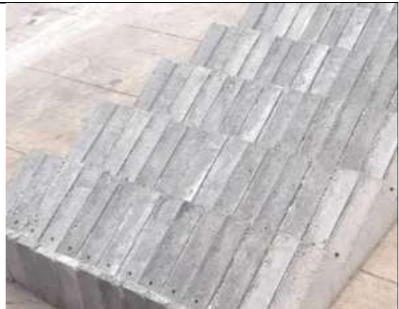
Limons d'escaliers prébétonnés, en masse
